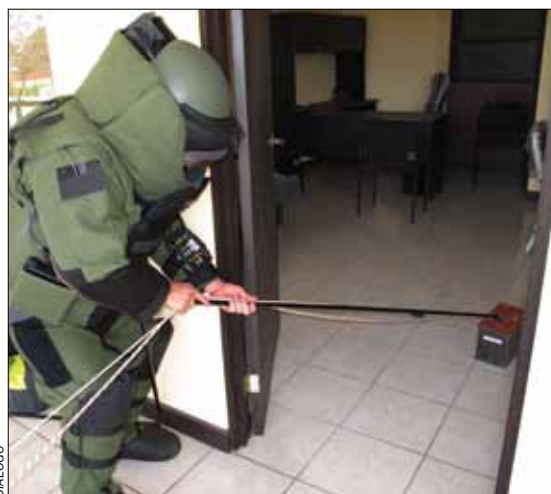
Um membro da UEI demonstra como o gancho e o equipamento de corda são utilizados para mover pacotes suspeitos.
