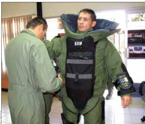
O Oficial Albert Bustamante usa uma roupa antibomba de modelo EOD9, que tem um dispositivo para controlar um ventilador, uma luz e um microfone.
