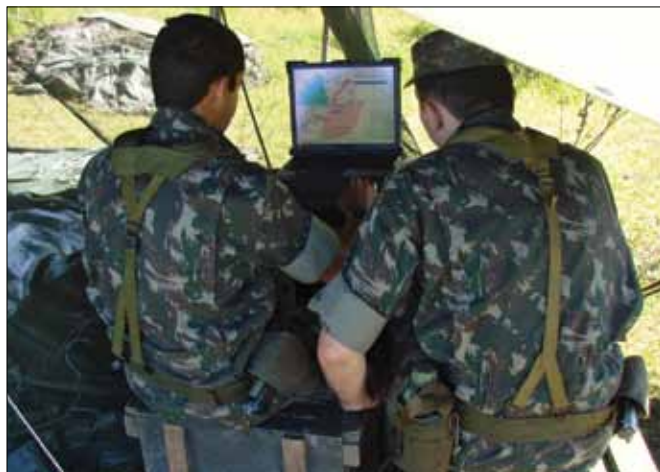
A interface do SABER M60 permite determinar a posição dos aviões detectados, assim como a altura, a distância e o ângulo em que estes se encontram em relação ao centro de operações antiaéreas.
